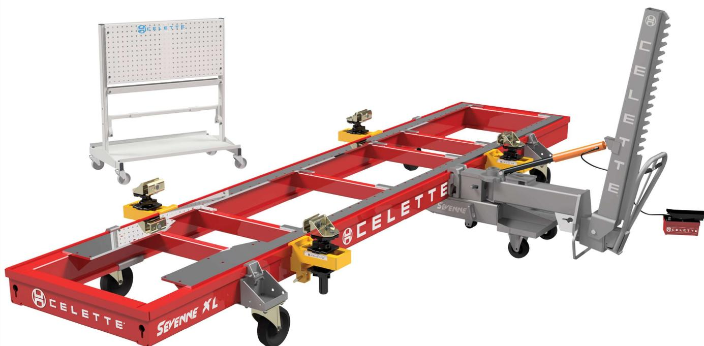
**Marbre mobile pour la réparation et le contrôle des véhicules**
